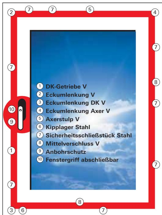
**Die Widerstandsklasse RC2N/RC2\* der mechanischen Absicherung baut auf der Widerstandsklasse RC1 auf**
