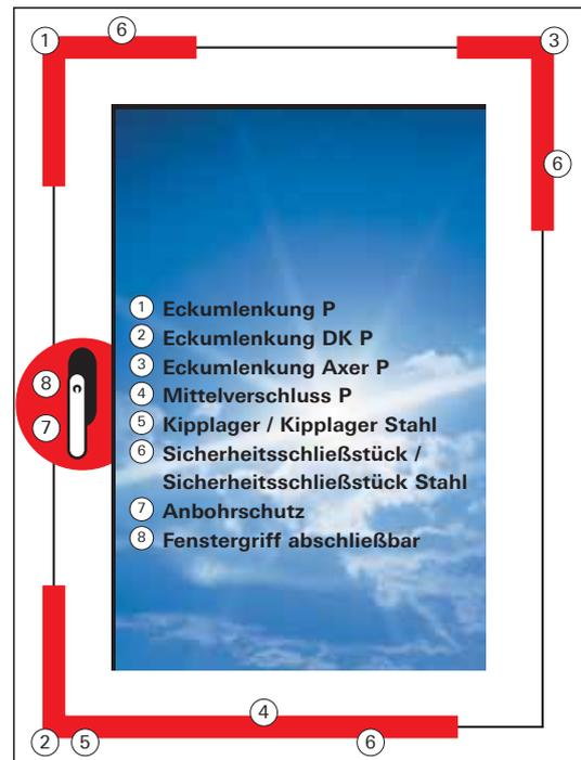
**In der Widerstandsklasse RC1N\* leistet der Beschlag ganze Arbeit gegen Versuche, das Fenster aufzubrechen**
