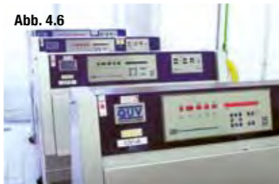
Abb. 4.6 Laborraum mit künstlichen Bewitterungsapparaturen analog EN 927-6
