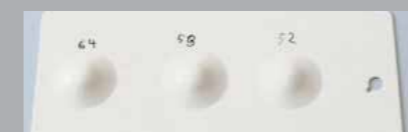
Abb. 9.8: An diesem Stahlblech wurde die Tiefungsprüfung nach DIN EN ISO 1514 durchgeführt.
