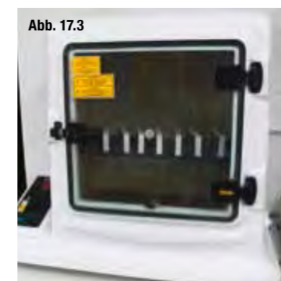
Abb. 17.3: Klimaapparat Kondenswasserklimate nach DIN EN ISO 6270-2.
