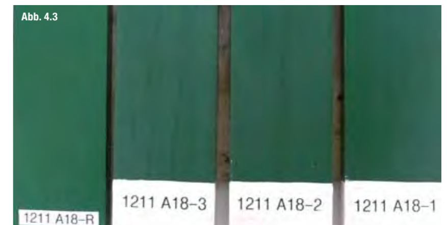
Anhand von drei bewitterten und einem unbewitterten Prüfling werden Glanzänderung, Farbänderung, Blasenbildung, Abblättern, Rissbildung, Kreidung, Schimmelbildung, Haftfestigkeit und das allgemeine Aussehen bewertet.
