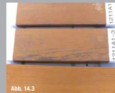
Beschichtung mit 3 Arbeitsgängen Cetol BL 21
