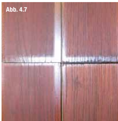
Abb. 4.7 Testhölzer nach mehrwöchiger Klimabelastung analog EN 927-6
