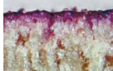
Simulation Penetrationsgefälle einer Imprägnierung auf Kiefernholz
