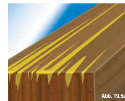
Abporen von rissigen Holzuntergründen
