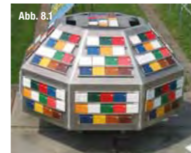
Abb. 8.1 Diamantförmiges Oktogon – ein Modell, um Bewitterungstests in Anlehnung an EN 927-3 zu perfektionieren (s. Seite 25), Standort Sassenheim, Niederlande
