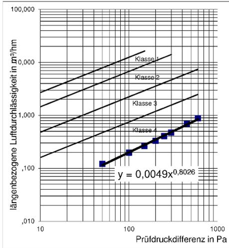
**Diagramm:** Längenbezogene Luftdurchlässigkeit (Mittelwert aus Winddruck und Windsog)
