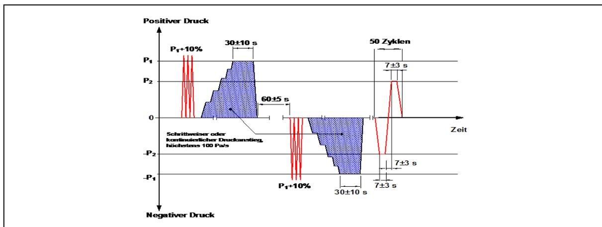
Abbildung Prüfablauf Windwiderstandsfähigkeit - Durchbiegung und Druck-Sog-Wechselast
