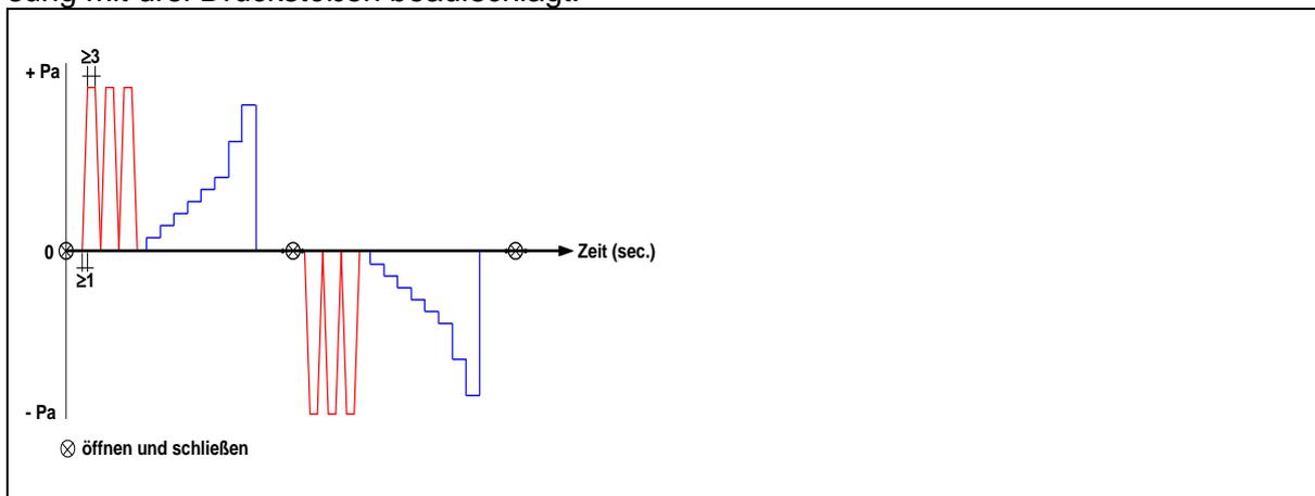
Abbildung Prüfablauf Luftdurchlässigkeit
