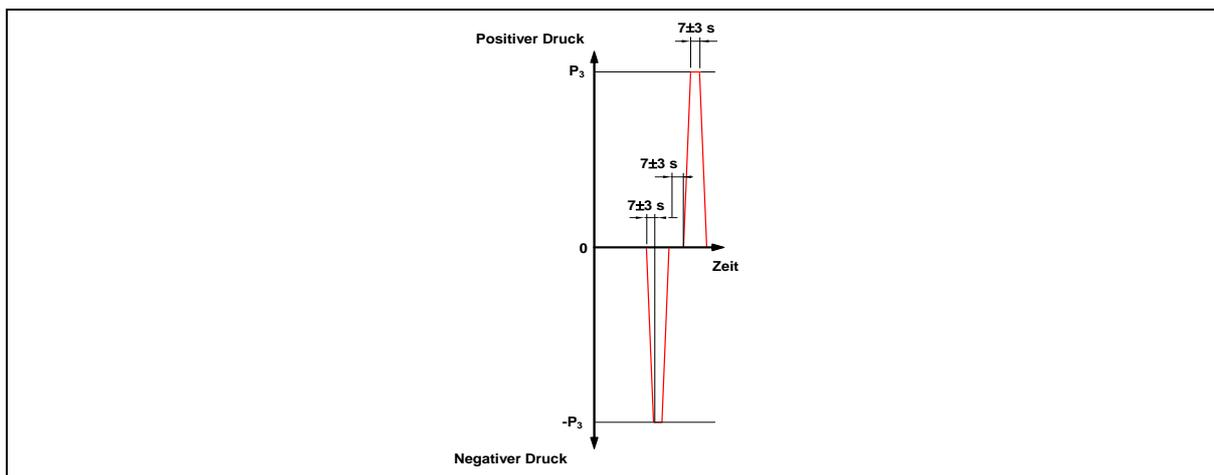
**Abbildung** Prüfablauf Windwiderstandsfähigkeit - Sicherheitsversuch
