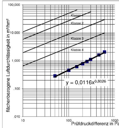
**Diagramm:** Flächenbezogene Luftdurchlässigkeit (Mittelwert aus Winddruck und Windsog)
