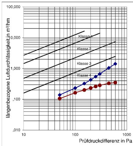
**Diagramm:** Längenbezogene Luftdurchlässigkeit (Winddruck und Windsog)
