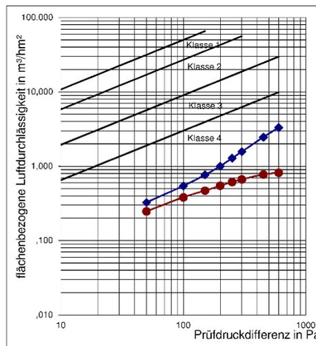
**Diagramm:** Flächenbezogene Luftdurchlässigkeit (Winddruck und Windsog)
