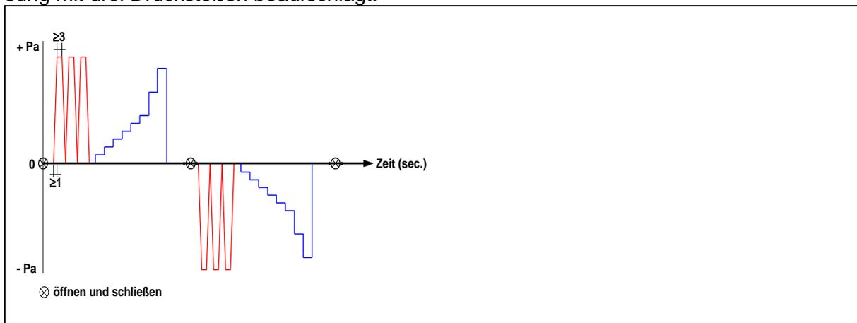
Abbildung Prüfablauf Luftdurchlässigkeit
