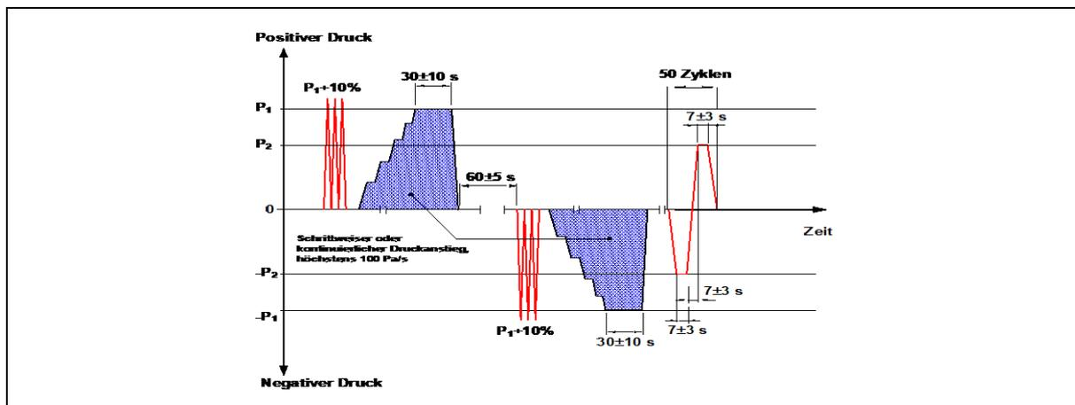
Abbildung Prüfablauf Windwiderstandsfähigkeit - Durchbiegung und Druck-Sog-Wechselast
