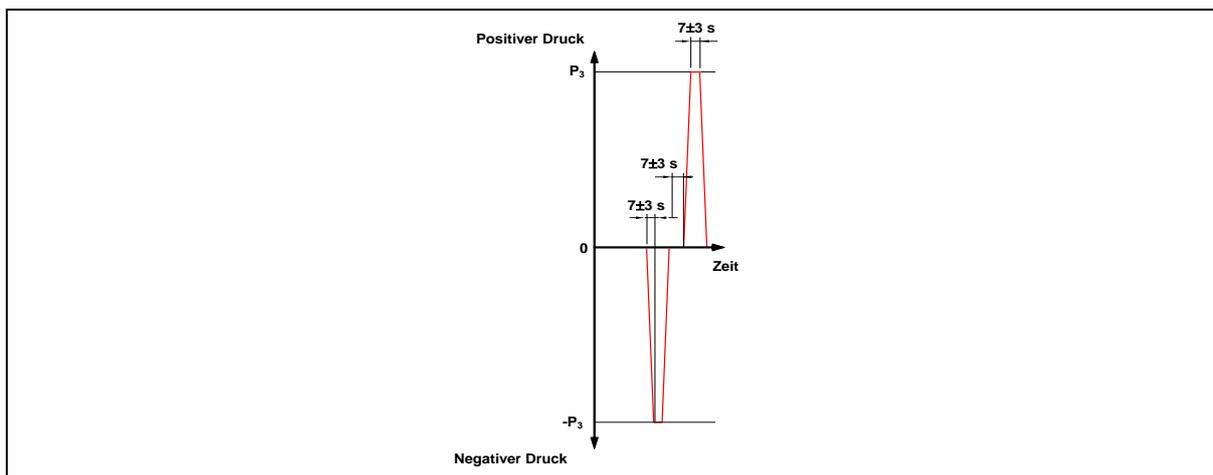
**Abbildung** Prüfablauf Windwiderstandsfähigkeit - Sicherheitsversuch
